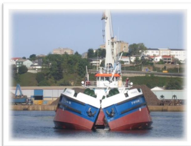
Abertura da draga para descarga pelo fundo
